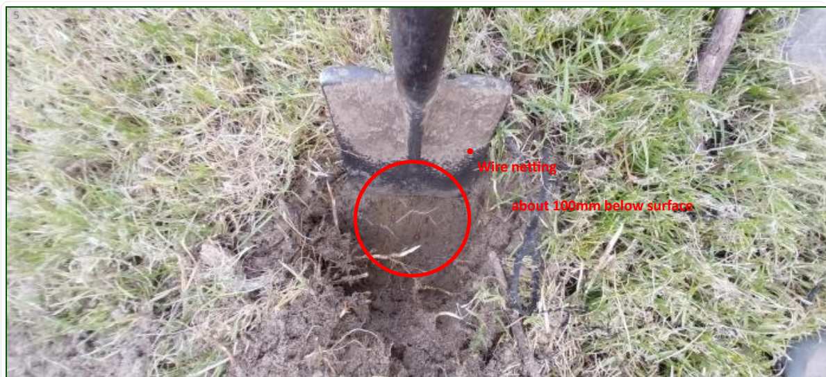
040 Wire netting 20240404_161439.jpg
